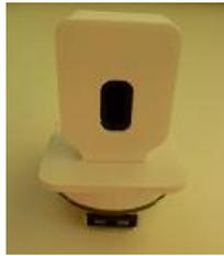
El sensor de luz nos indica la cantidad de luz ambiente que recibe la ciudad inteligente. Funciona a través de un componente electrónico llamado fotodiodo, el cual genera una corriente eléctrica en función de la cantidad de luz que incide sobre él. Proporciona un valor entre el 0% (oscuridad total) y el 100% (luz intensa).
