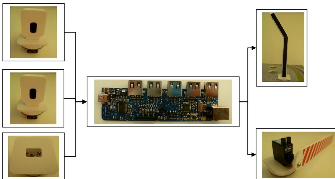
A continuación se indica las posiciones en las que se colocan los elementos para esta práctica, así como el puerto de la tarjeta controladora al que se conectan. Como en otras prácticas, las farolas se conectan en serie, desde el puerto **CON3 / I<sup>2</sup>C**.
